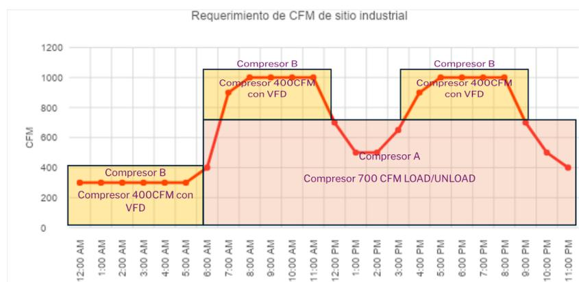
Figura 1. Secuenciación de dos compresores de tornillo (rojo: LOAD/UNLOAD y amarillo: VFD).
